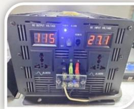
5 轉換器：直流轉換成交流電110V，供電器使用
